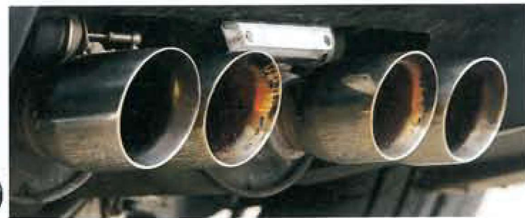
Voice of America: Geiger erweitert die ab Werk optional lieferbare Klappen-auspuffanlage um eine auf Knopfdruck wählbare „Dauerauf“-Funktion
