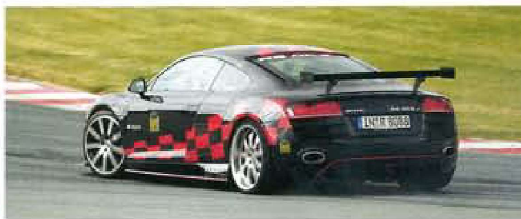
Wisch und Heck: Driften ist wegen der fehlenden Zugfunktion der Vorderachse im hinterradgetriebenen MTM R8 anspruchsvoller als im Serienauto
