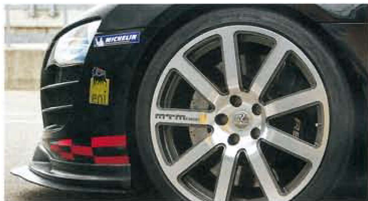
Klassische MTM-Kombination: Bimoto-Rad und gekörnte, 380 Millimeter große Vorderachsbremse mit ausdauerndem Biss – auch auf der Piste
