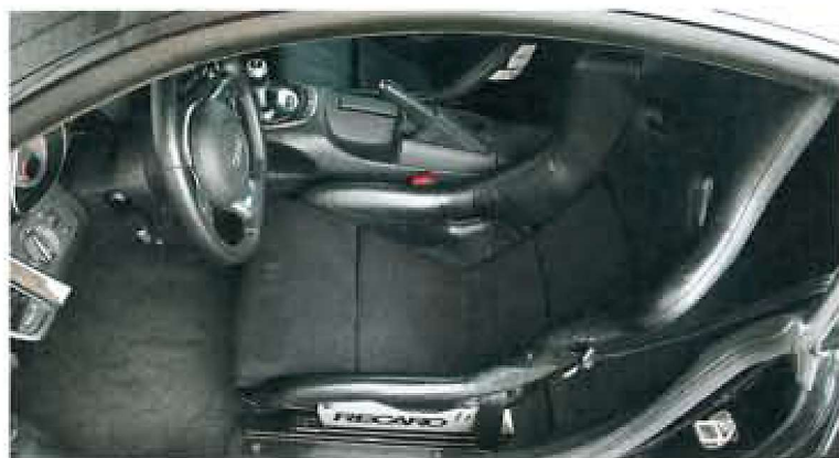
Griffig: Recaro-Schalensitze mit hervorragender Kontur halten den Piloten jederzeit fest, sind aber wegen der nötigen Konsole etwas hoch montiert
