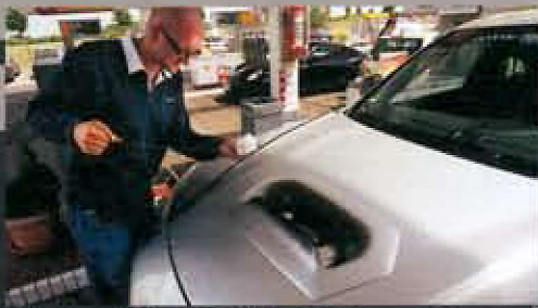
Schwarzes Loch mit Funktion: Zur Messung des Ölstands kann die Haube geschlossen bleiben
