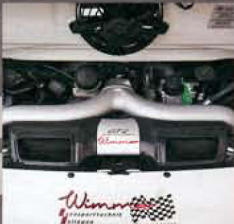
Pure Performance: Wimmer hat die Verdichterräder der VTG-Lader modifiziert. Damit erhöht er die Leistung von 530 auf 650 PS
