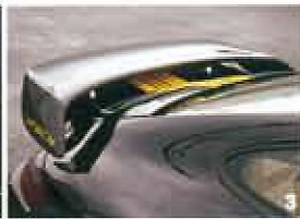
1.チューナーGPスペックのパワーキットで強化。2.排気系はレーシングマニホールド、スポーツエキゾーストおよびキャタライザー、テールパイプが装着される。3.リヤウイングを含め、リップスポイラーやドアミラーなどすべてカーボン製。ドレスアップというより軽量化とエアロダイナミクス効果を狙った機能パーツとして設計される。
