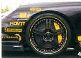
4.機密に徹した硬派なデザインの鍛造ホイール「GT4」を採用し、タイヤはP245/30R20、P225/25R20、Mov'itのセラミックブレーキシステムは、カメラカーを凌ぐ。5.フロントフード内に収まっているバンク修理キット用の純正コンプレッサーを用い、フロントの車高を調整するエアリフターを装備。後付けパーツを追加しないため、重量増に繋がらないナイスアイデアだ。アップ&ダウン操作はリモコンによって可能になっている。取材車はビルシュタインの816クラブスポーツに組み合わされていたが、純正ダンパーにも対応する。
