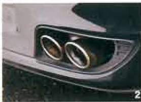
1.チューナーGPスペックのパワーキットで強化。2.排気系はレーシングマニホールド、スポーツエキゾーストおよびキャタライザー、テールパイプが装着される。3.リヤウイングを含め、リップスポイラーやドアミラーなどすべてカーボン製。ドレスアップというより軽量化とエアロダイナミクス効果を狙った機能パーツとして設計される。
