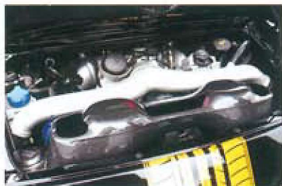
チューナーGPスペックのパワーキットで強化。排気系はレーシングマニホールド。スポーツエキゾーストおよびキャタライザー、テールパイプが装着される。
