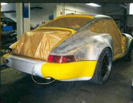
**Radläufe neu angepasst:** Oberste Maßgabe war die bündige Abdeckung der "Cargraphic Racing"-Sonderräder
