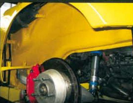
**Zentrale Positionen neu besetzt:** Bilstein-Gewinde-Stoßdämpfer des Typs "B16/PSS10", aufgearbeitete Achsteile
