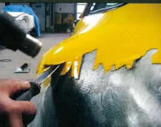
**Der Lack ist ab:** Mittels Heißluftpistole und Spachtel werden die Farbschichten bis aufs blanke Blech abgetragen
