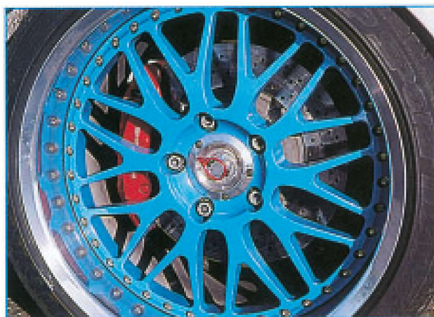
Warm ausgelagert: Die Behandlung der Felgensterne verhindert gefährliche Risse
