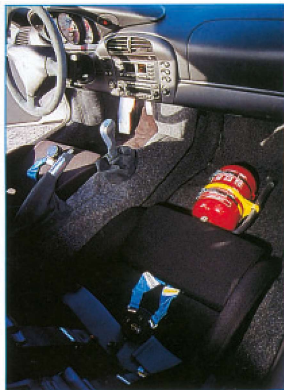
Auf dem Boden geblieben: Leichtbau-Teppich schützt durchlackiertes Elfer-Blech
