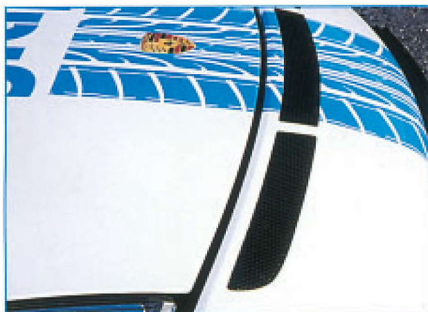
Nicht nur Zierat: Die Entlüftung des mittleren Wasserkühlers unterstützt die Bodenhaftung
