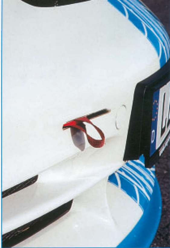
Abschleppen leicht gemacht: Hier muss keine Öse umständlich hineingedreht werden!
