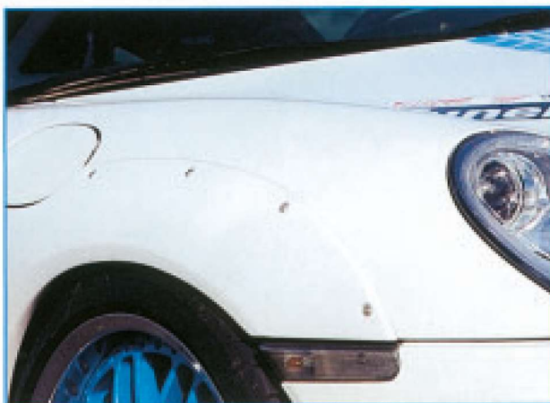
Aufgesetzt, angeschraubt: Ruf lieferte einen vor allem in den USA bekannten Verbreiterungssatz
