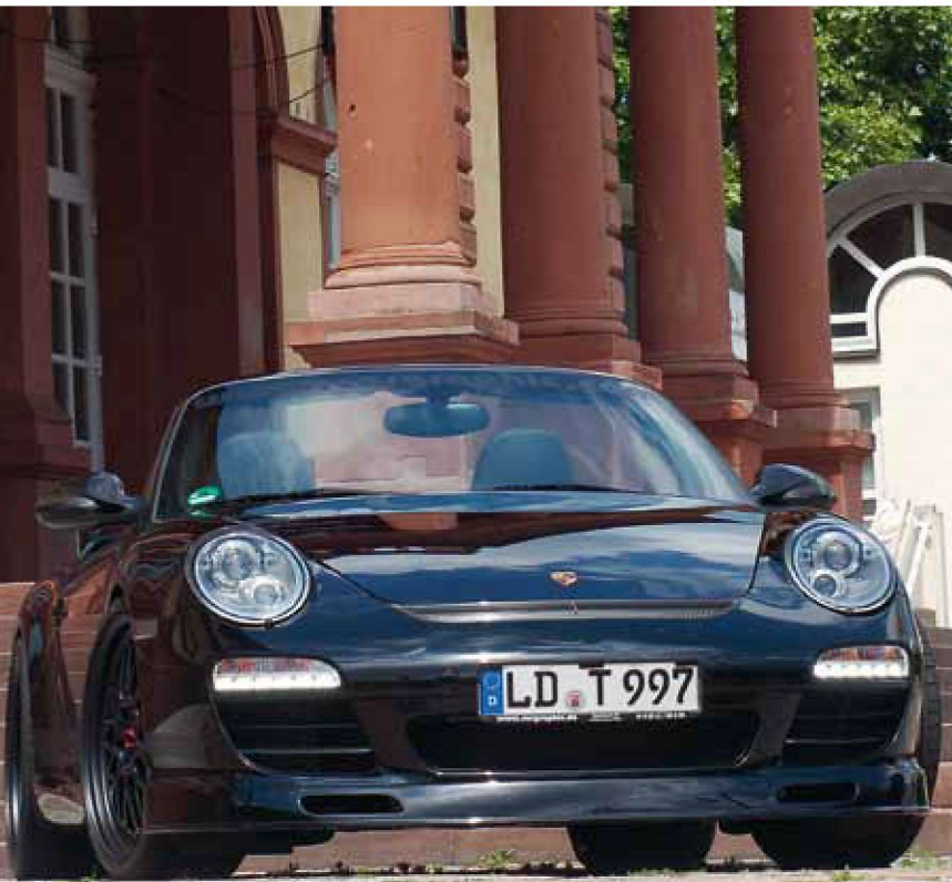
Souverän über Problemzonen hinweg: Mit der Cargraphic-"Airlift Suspension" lässt sich das 997 Cabriolet an der Vorderachse um bis zu 55 Millimeter (72 am Frontspoiler) anheben
