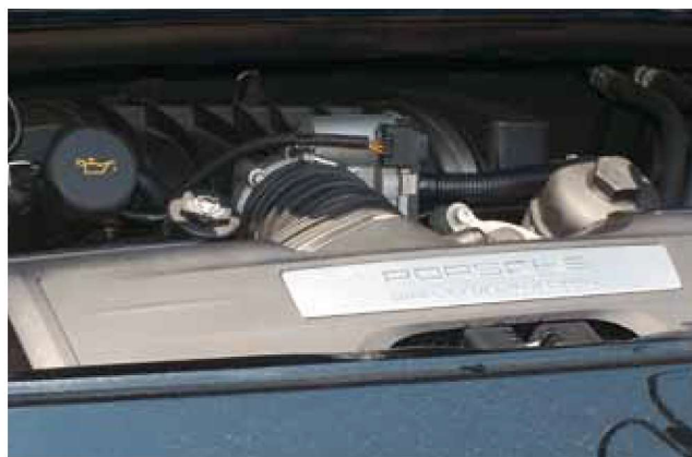
Energieeffizient und ab Werk mit 385 PS bei 6.500/min angegeben: 3.800 ccm großer Sechszylinder-Boxer im 997 Carrera S Cabriolet mit Benzin-Direkteinspritzung
