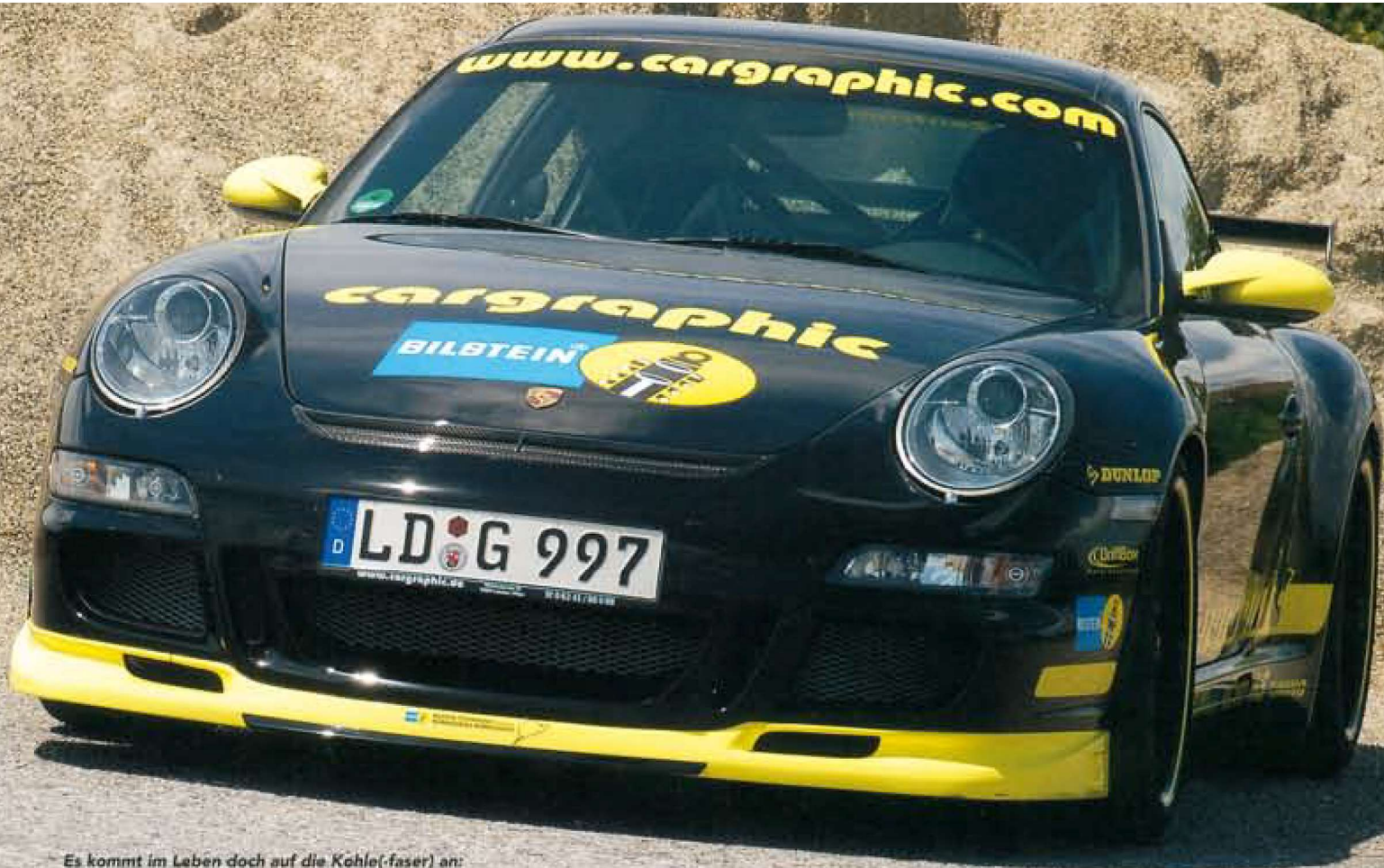
Es kommt im Leben doch auf die Kohle(-faser) an: vorderer Gepäckraumdeckel aus dem Werkstoff, der die Formel 1 revolutionierte
