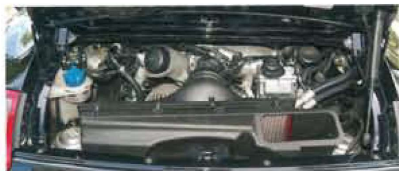
Koproduktion: Reinhold Schmirler (RS Tuning, Kirchhaslach) und die Landauer Gebrüder Schnarr erweiterten den Hubraum von 3.600 auf 3.995 ccm
