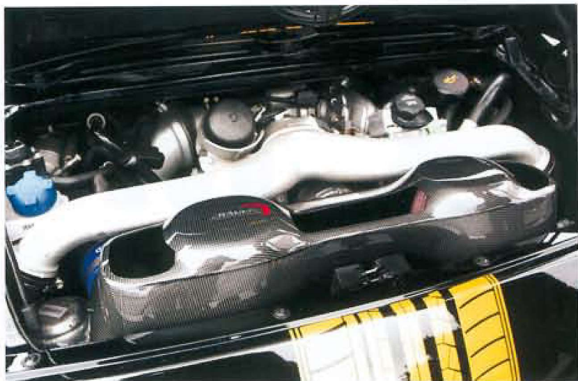
チューナーGPスペックのパワーキットは、ECUのアップグレードやレーシングマニホールド、スポーツエキゾースト(25psアップ)、スポーツキャタライザー、インタークプレナム、スポーツエアフィルターなどで構成される。エンジンルームはK&N製ラムチューンチャーが目立つ程度で、華美を好まないカーグラフィックらしい仕上がり。
