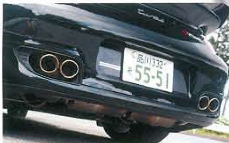
テールは80mm×4のラウンドタイプ。997ターボは他に88×77mm×4のオーバルタイプも選ぶことができる。
