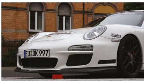
С SAGRAPHIC AIRLIFT КРОМКА ПЕРЕДНЕГО БАМПЕРА ПОДНИМАЕТСЯ НА 72 ММ ВСЕГО ЗА 1,5 СЕКУНД
