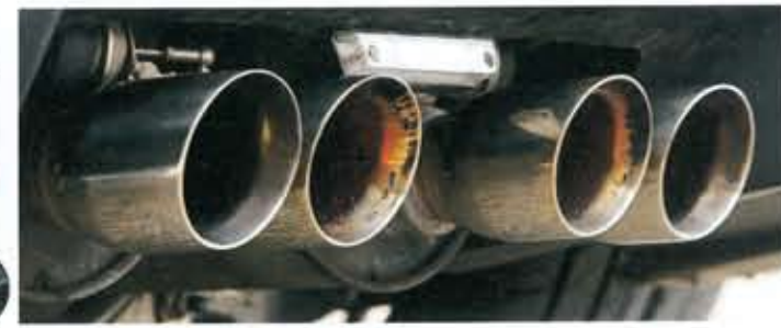
Voice of America: Geiger erweitert die ab Werk optional lieferbare Klappen-auspuffanlage um eine auf Knopfdruck wählbare „Dauerauf“-Funktion
