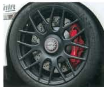
Umgerüstet: Cargraphic nutzt größere Räder und Reifen vom GT3 RS
