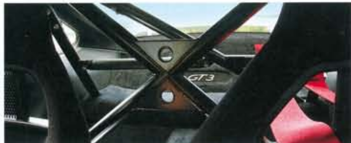
Sicher ist sicher: Auch der Überrollkäfig in geschraubter Ausführung gehört zum werksseitig ohne Aufpreis lieferbaren Clubsport-Paket
